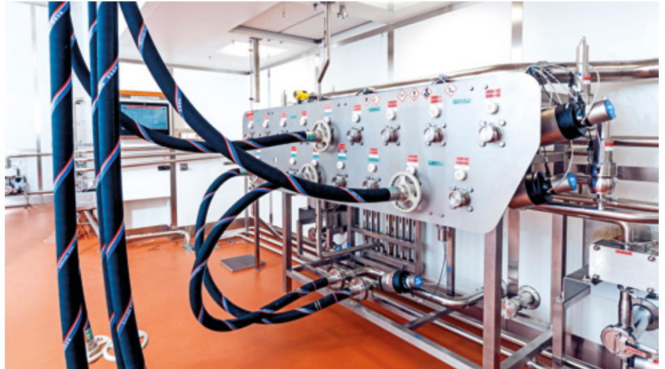
Turcks BL ident-RFID-System verhindert Fehlkupplungen und gewährleistet damit eine konstante Produktqualität
