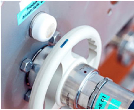
Sobald der Schlauch verbunden ist, verifiziert das RFID-System den Anschluss
