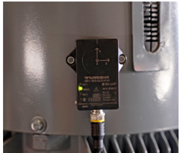
Der kombinierte Vibrations- und Temperatur-Sensor CMVT erfasst Vibrationen über drei Achsen und wertet sie intern aus
